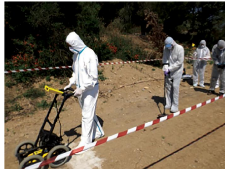
تصویر ۵: بررسی میدانی برای یافتن اشیاء و اجسام مدفون در زمین به وسیله رادار نفوذ زمین (GPR) (Barone, 2018: 57)
